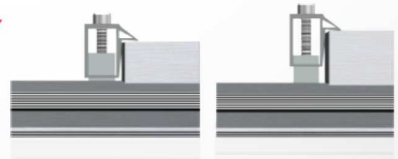
Abrazadera de remate con resorte ajustable a paneles de 30-50 mm
